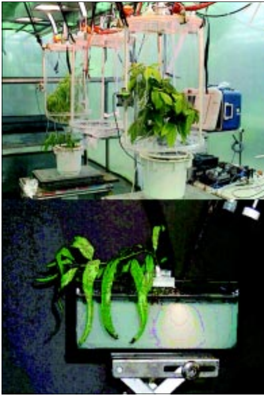
Amazonische Bäume im Labor. Oben: Teflonküvette zur Messung volatiler organischer Substanzen, die über die Blätter der Bäume bei Überflutung emittiert werden. Unten: Messung des Sauerstoffgehaltes im Wurzelgewebe und im Wurzelraum durch Mikroelektroden. (Abb. 3)
