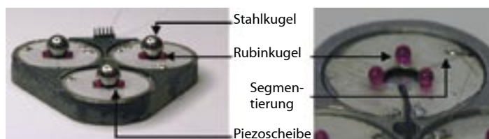
Abb. 2 (links): Aufbau der mobilen Plattform.
