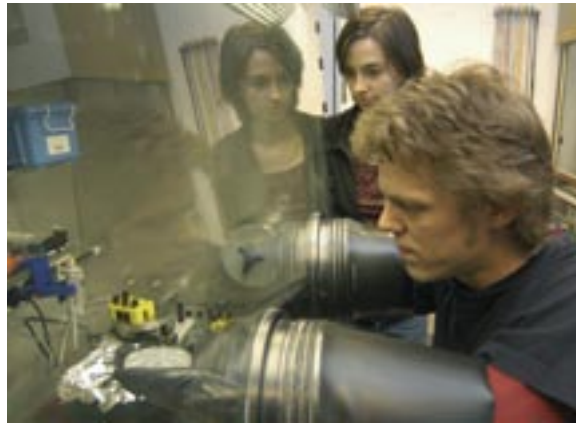
Abb. 1: Die Präparation und Verkapselung von Laborproben findet zur Vermeidung von Sauerstoff- und Luftfeuchtigkeitseinfluss in einer Inertgas-Atmosphäre statt (2-Kammer-Glove-Box-System).
