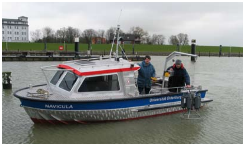
Speziell für die Forschungsarbeiten im Wattenmeer konstruiert: das neue Aluminium-Boot „Navicula“. Es wurde im Februar getauft und ist damit die neueste Errungenschaft der ICBM-Meeresstation in Wilhelmshaven. Mit sechseinhalb Metern Länge und etwa zweieinhalb Metern Breite wird das Schiff auch für die regelmäßigen Fahrten zum Messpfehl vor Spiekeroog genutzt.
