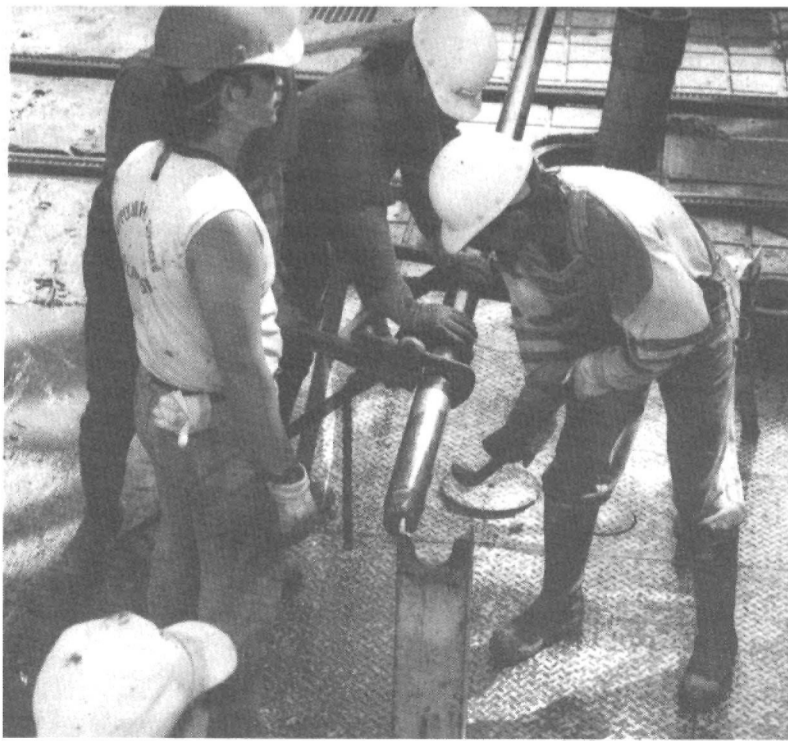
Ein spannender Augenblick: das Kernrohr ist im Inneren des Bohrgestänges an Bord geholt worden und wird geöffnet.
