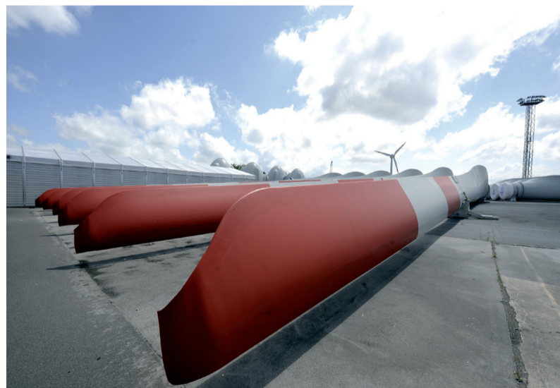
Rotorblätter des Windparks BARD Offshore 1: Jedes Blatt ist knapp 60 Meter lang und wiegt etwa 28 Tonnen. Foto: BARD-Gruppe
