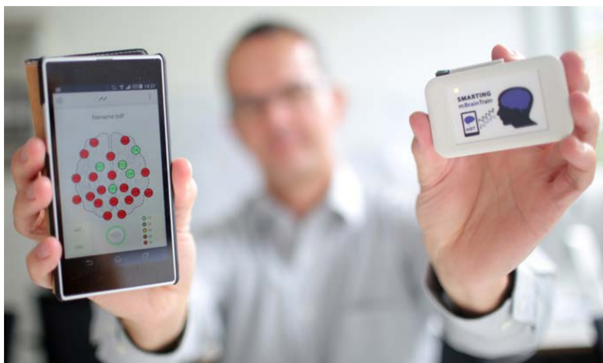
Mobile EEG-Technik: rechts der miniaturisierte Prototyp, der die Hirnsignale aufzeichnet.
