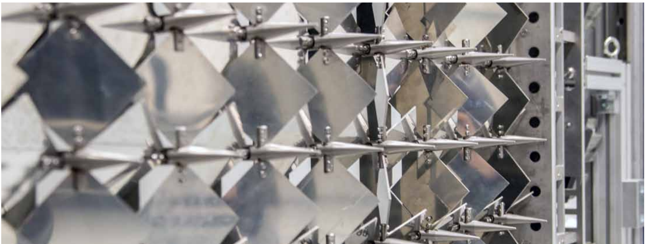
Was wie abstrakte Kunst anmutet, ist ein Schlüsselement des neuen Windkanals: das drei mal drei Meter große „aktive Gitter“. Es erzeugt Turbulenzen, denen Windenergieanlagen in der Natur ausgesetzt sind. Die Luft wird dafür durch flexibel einstellbare Klappen geblasen, bevor sie dann auf Rotorblattprofile in der Messstrecke trifft. Foto: Daniel Schmidt
